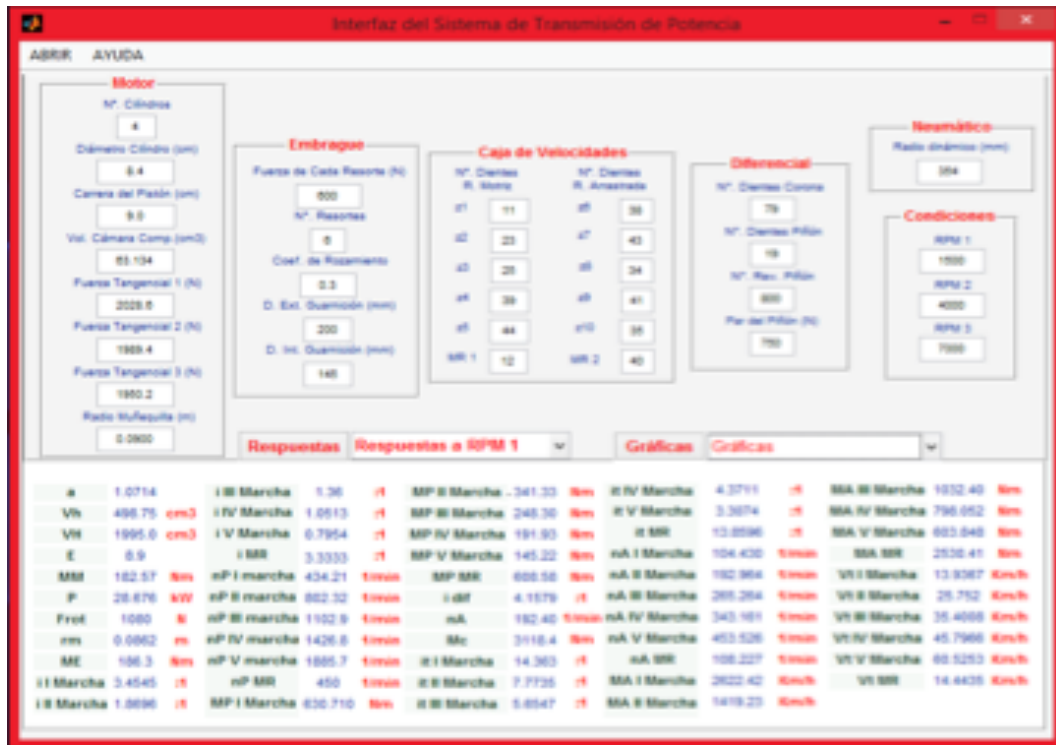
Figura 5: Simulador de Cálculos del Sistema de Transmisión de Potencia (Ventana de entrada de datos y visualización de resultados numéricos)
