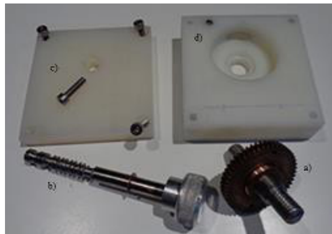
Figura 9.- Rotador elaborado de partes recicladas; a) Piñón de bronce de 52 dientes, b) Tornillo sinfín de rosca doble, c) Tapa de nylon con eje, d) Zócalo de nylon vaciado con eje.
