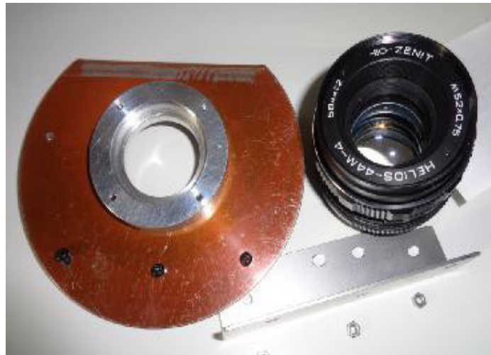
Figura 1.- Lente regulable con sus nuevos acoples.
