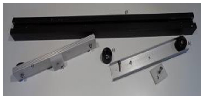
Figura 13.-Partes del chasis: a) y b) Apoyos de caucho, c) y Perfil de aluminio en C, e) y f) Guías rectangulares roscadas y pulidas, g) Perfil de aluminio acanalado y anodizado en negro.
